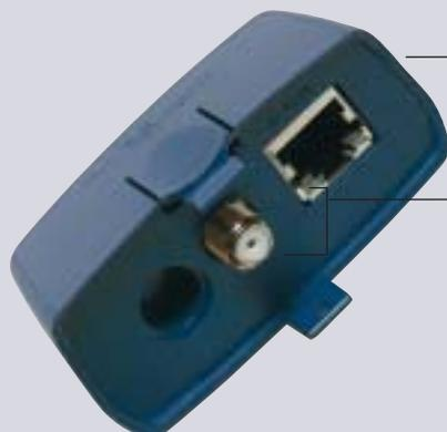
**Remote-Adapter** zur Prüfung vorhandener Kupferverkabelungen – Zweitfunktion als Schutzkappe
