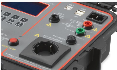
Anschluss für externen Stromzangenadapter (optional Beha-Amprobe CHB 1) zur Messung von Schutzleiterströmen auch an 3-phasigen Prüflingen (nur GT-900).
