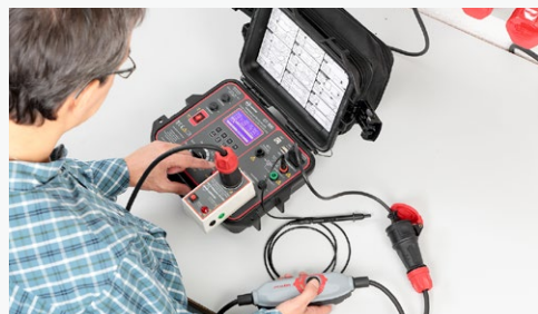
Prüfung von ortsveränderlichen Fehlerstrom-Schutzschaltern (PRCD, PRCD-S, PRCD-S+, PRCD-K) (nur GT-900).
