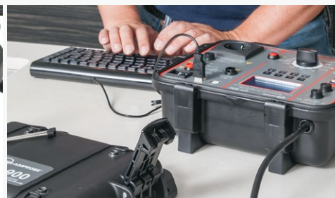
Drei separate USB-Schnittstellen zum gleichzeitigen Anschluss an PC und Eingabegeräten wie USB-Tastatur, USB-Barcodescanner, USB-Speicher oder Bluetooth Geräte mit USB-Dongle (optional)
